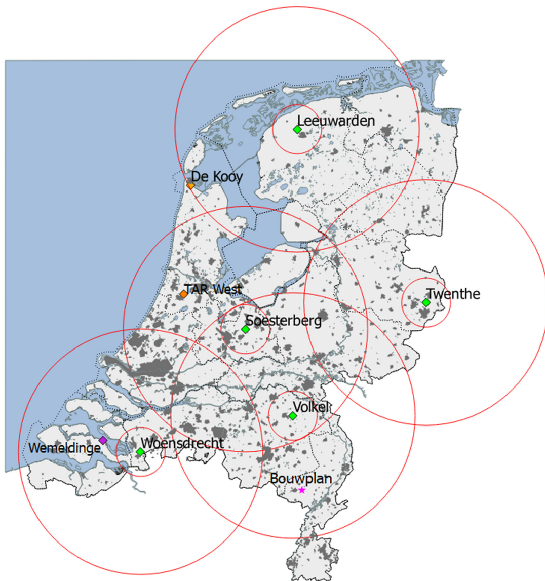
Figuur 2. Locaties van de vijf MASS verkeersleidingsradarsystemen (groene ruit) met daaromheen de 15 en 75 km cirkels. De TAR West radar bij Schiphol en de extra MASS radar bij De Kooy zijn aangegeven met een oranje ruit. De geplande radar te Wemeldinge is weergegeven met een paarse ruit. De donkergrijze vlakken zijn de in de AHN-1 gedefinieerde stedelijke gebieden. De ligging van het te toetsen bouwplan is aangegeven met een roze ster.
