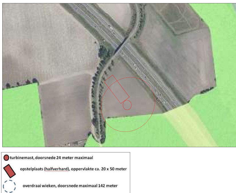
Figuur 8 : Overlap van de 'overdraai' van de wieken van de turbines met de Goudgroene natuurzone (Limburg Atlas, 2017).
