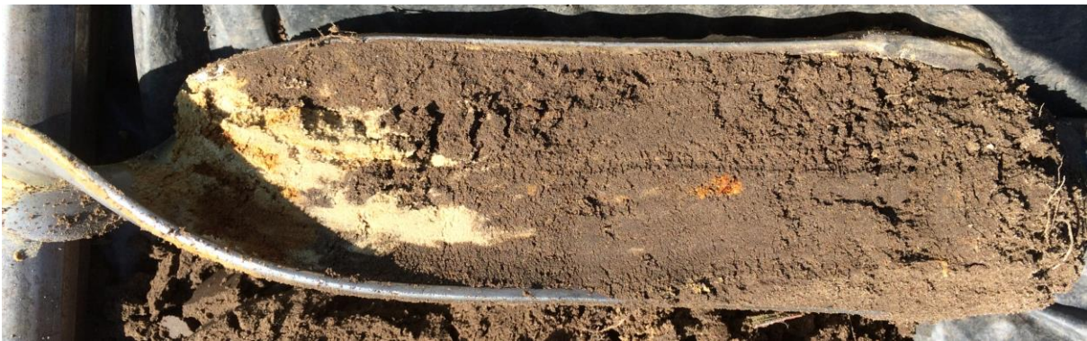
Boring 8: scherpe overgang bouwvoor naar C(g)-horizont
