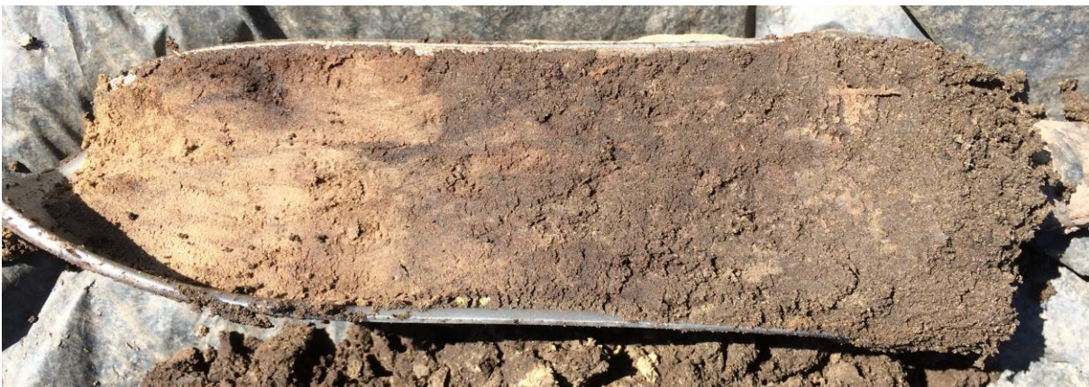
Boring 14: overzicht bouwvoor-dekzand
