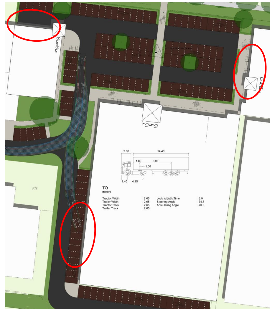
Figuur 18: rijcurves trekker met oplegger
