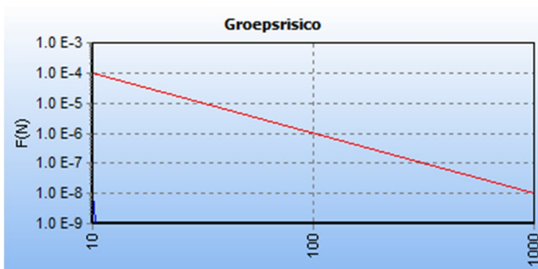
Afbeelding 11 fN-curve buisleiding A-585-deel-1, huidige situatie
