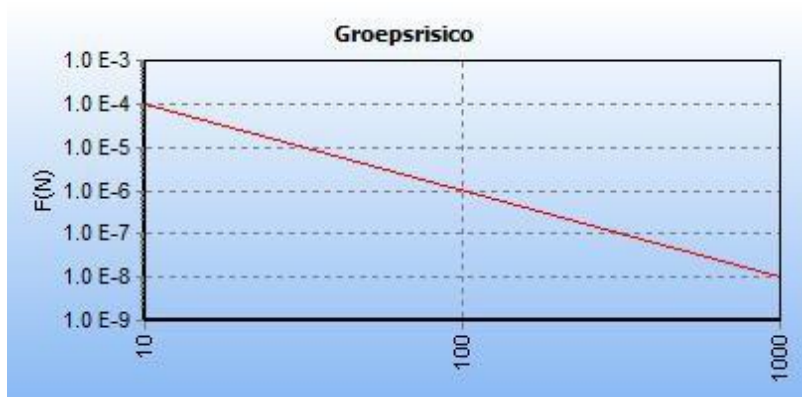
5.5 Figuur 5.5 FN curve voor 5683_leiding-Z-540-18-deel-1 van N.V. Nederlandse Gasunie voor de kilometer tussen stationing 0.00 en stationing 130.00
