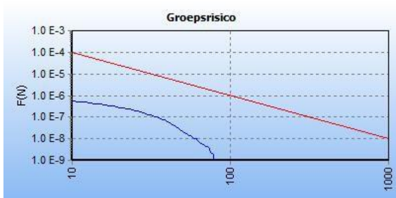
5.5 Figuur 5.5 FN curve voor 5683_leiding-Z-540-18-deel-1 van N.V. Nederlandse Gasunie voor de kilometer tussen stationing 0.00 en stationing 130.00
