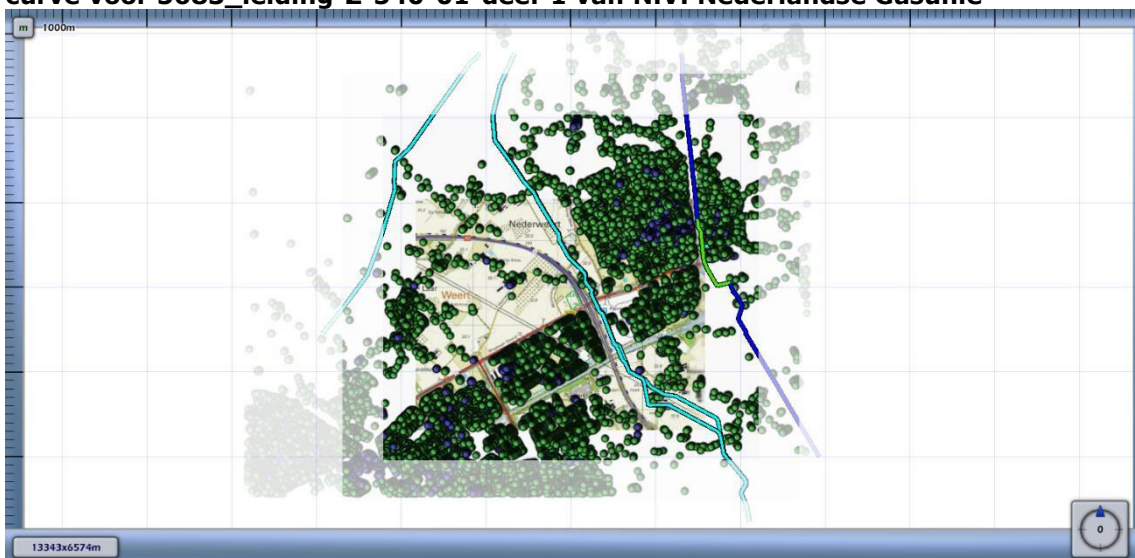
Figuur 4.4 Kilometer leiding behorende bij de maximale overschrijding van de FN-curve voor 5683_leiding-Z-540-01-deel-1 van N.V. Nederlandse Gasunie
