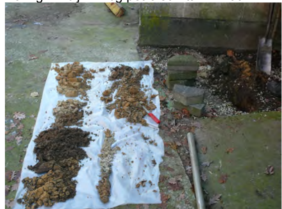
Boring B3 bij vml bg petroleumtank 600 l
