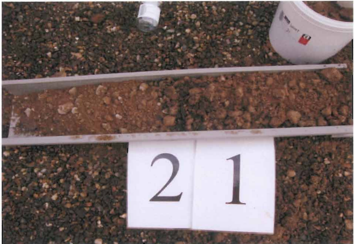
foto 3: uitkomend materiaal inspectiegat 21 (0 – 0,4 m-mv).
