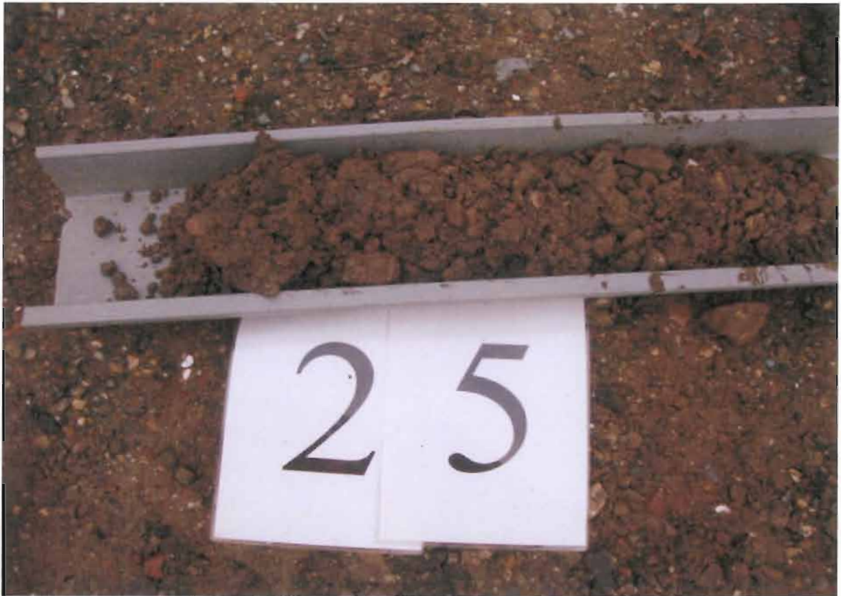
foto 5: uitkomend materiaal inspectiegat 25 (0 – 0,3 m-mv).
