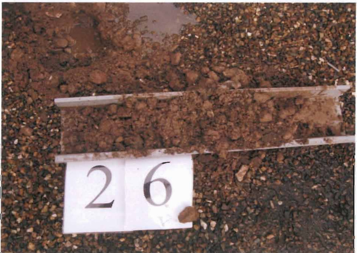
foto 6: uitkomend materiaal inspectiegat 26 (0 – 0,2 m-mv).
