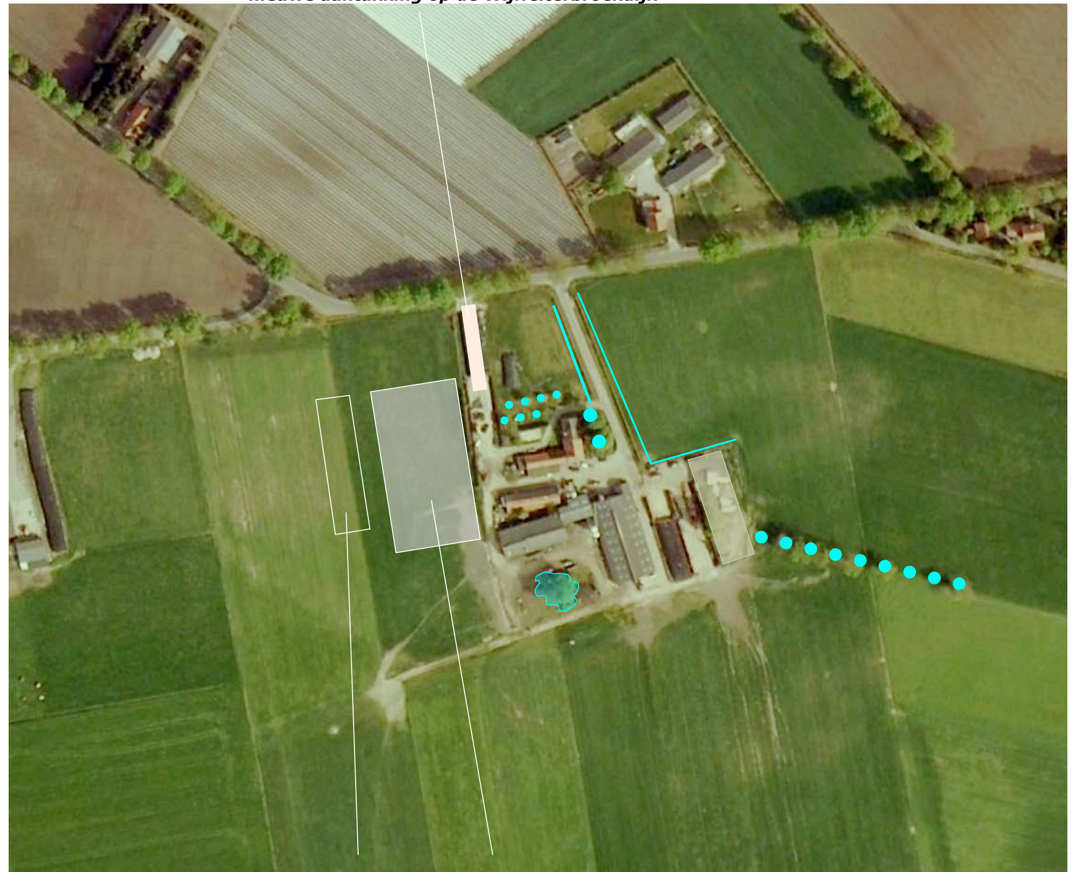
te realiseren sleufsilo, rundveestal
