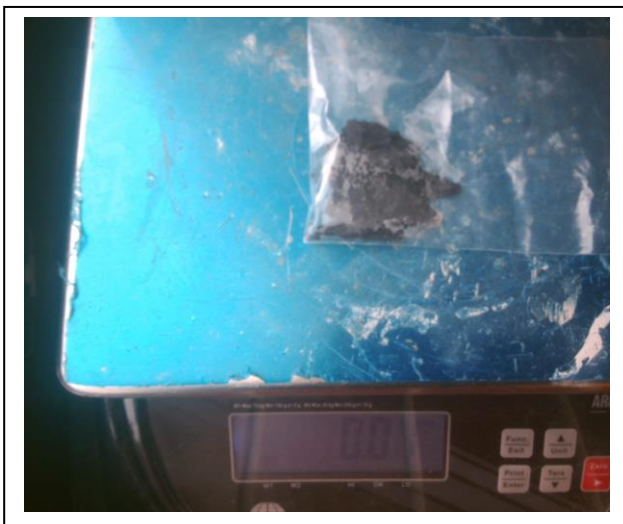
Foto 5. Aangetroffen asbest plaatmateriaal nabij inspectiegat 106
