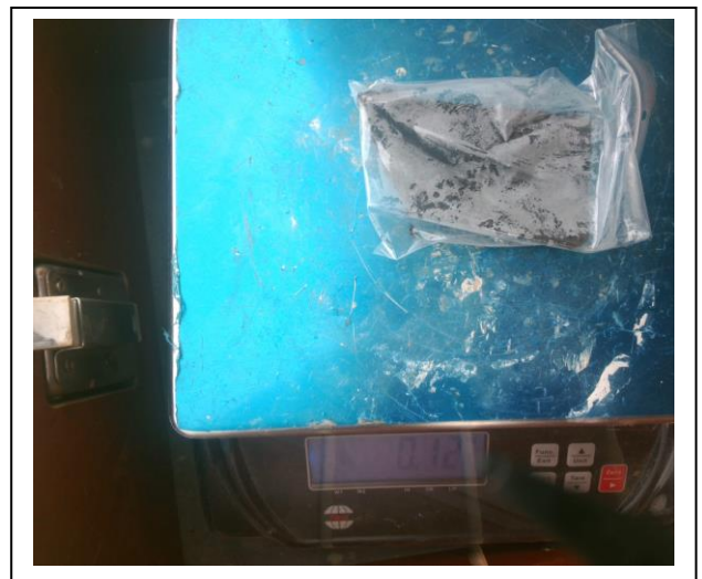
Foto 6. Aangetroffen asbest plaatmateriaal nabij inspectiegat 107
