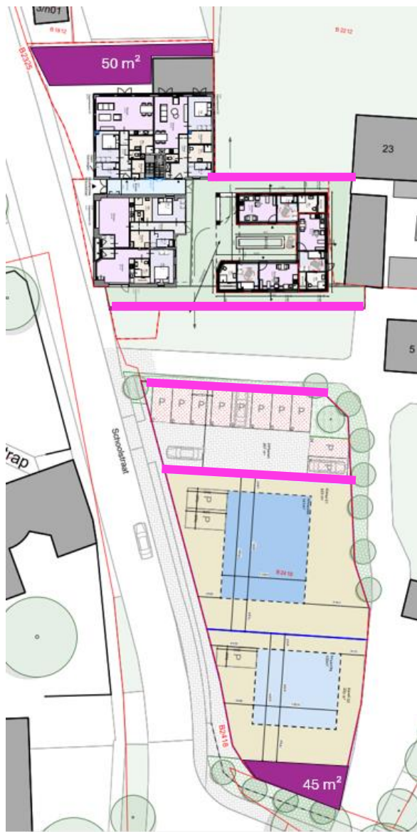
Figuur 6-2 Situatieschets locatie greppels (roze lijnen) en wadi's (paarse vlakken).
