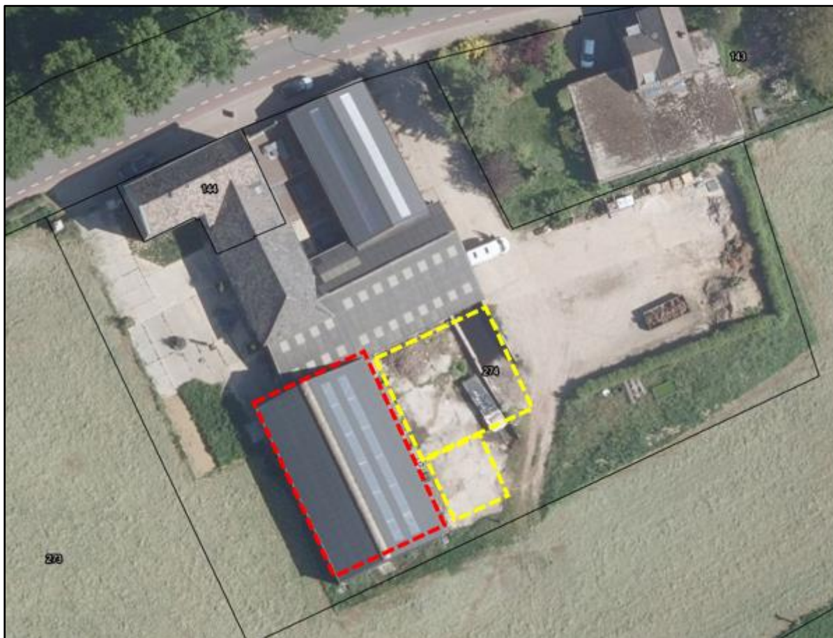
Afbeelding 13. Te slopen bebouwing is rood omlijnd, de te verwijderen verhardingen zijn geel omlijnd.
