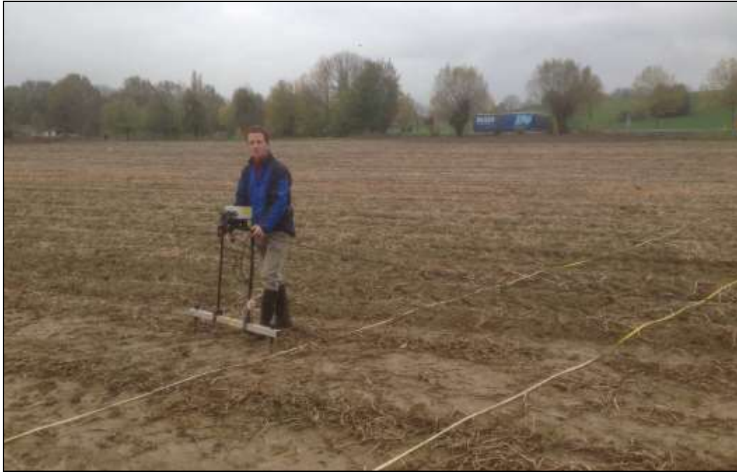
Figuur 17: Weerstandsmetingen in het veld.
