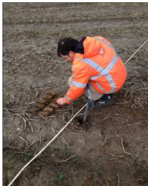
Figuur 21: Het onderzoek van een controleboring.
