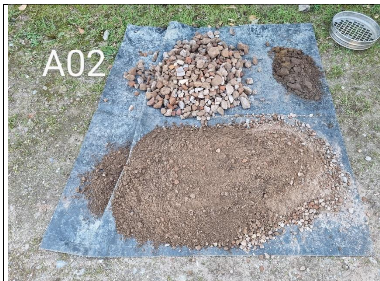
Uitkomend materiaal proefgat A2
