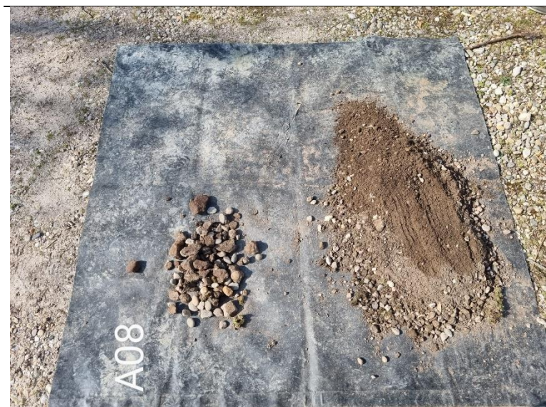
Uitkomend materiaal proefgat A8
