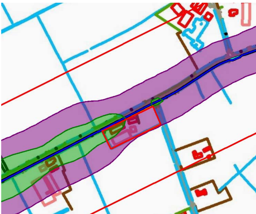
Figuur 4.1: Plaatsgebondenrisicocontour leiding N-541-15
