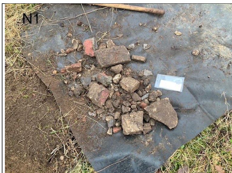
Foto 2: asbestverdacht materiaal N1 (14 januari 2022)
