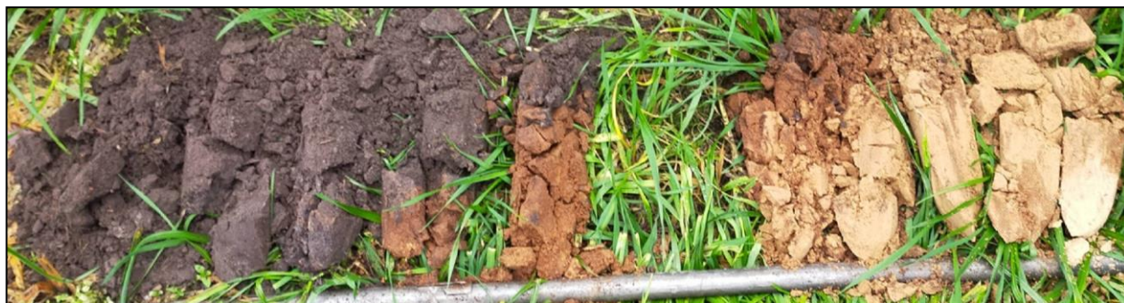
Figuur 6: Profielopname van boring 1, leesrichting van links naar rechts (Foto: januari 2020).
