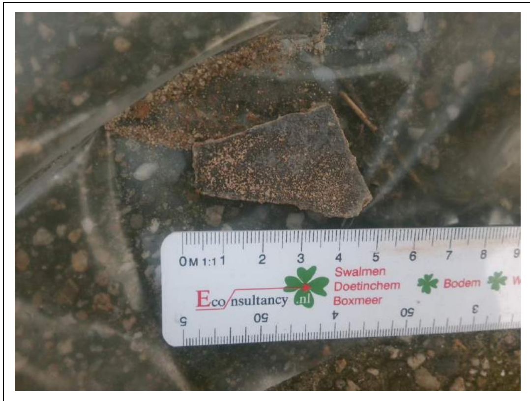
Foto 5. Asbest plaatmateriaal gat 04
