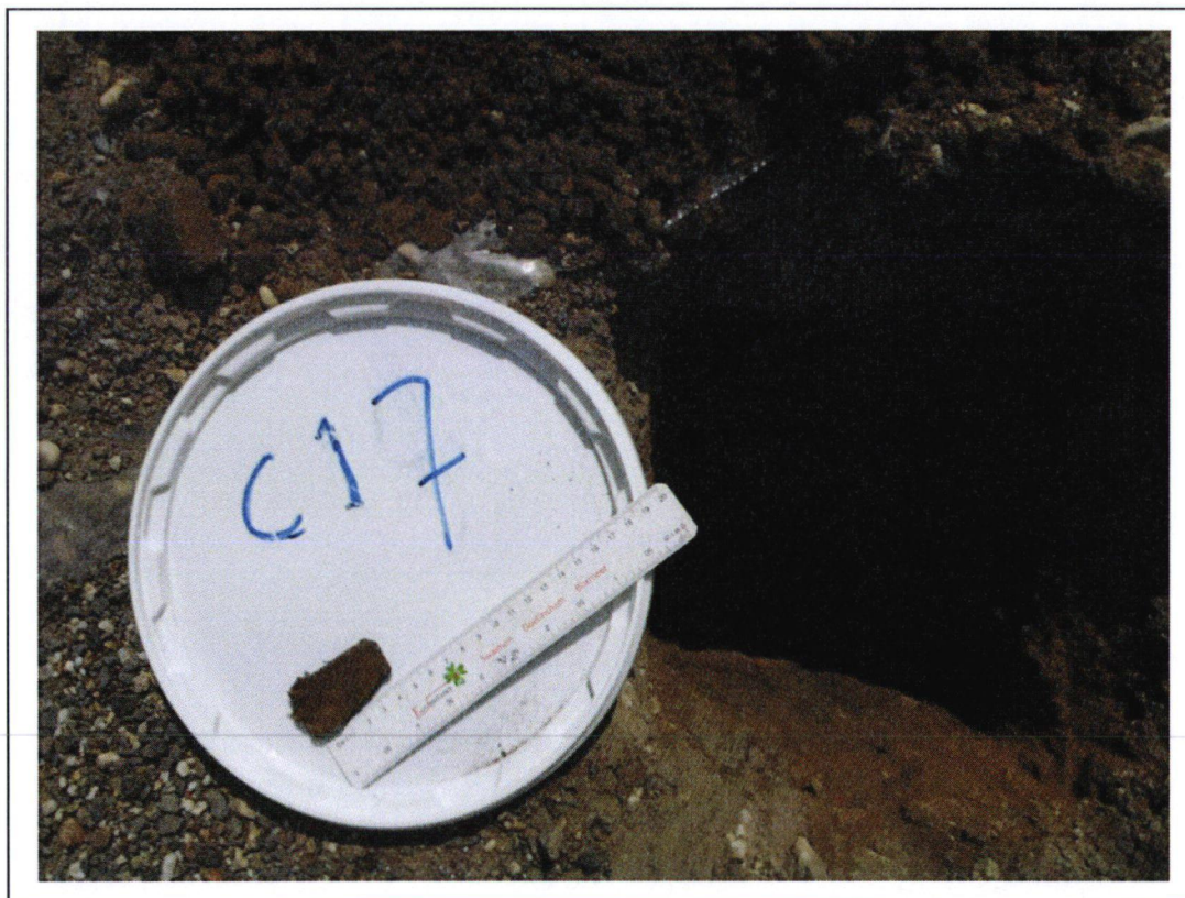
Gat C17 (asbestverdacht materiaal)
