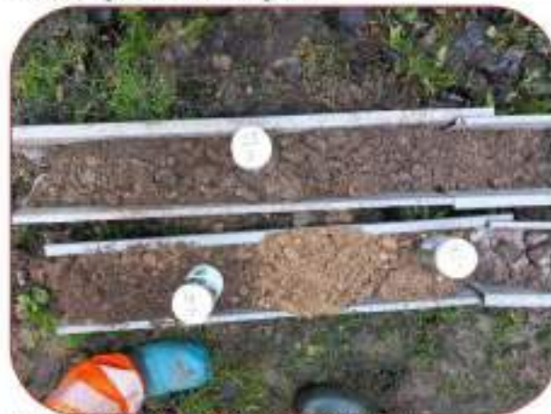
Foto 4: Boring 15 boven- en ondergrond tot 1,5 m-mw
