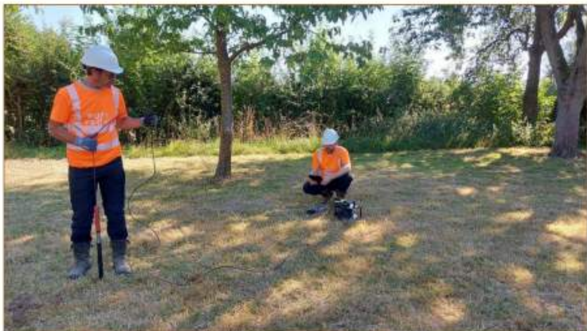
Afbeelding 2: Realtime detectie met behulp van een sonde en haspel (Bron: Euroradar).
