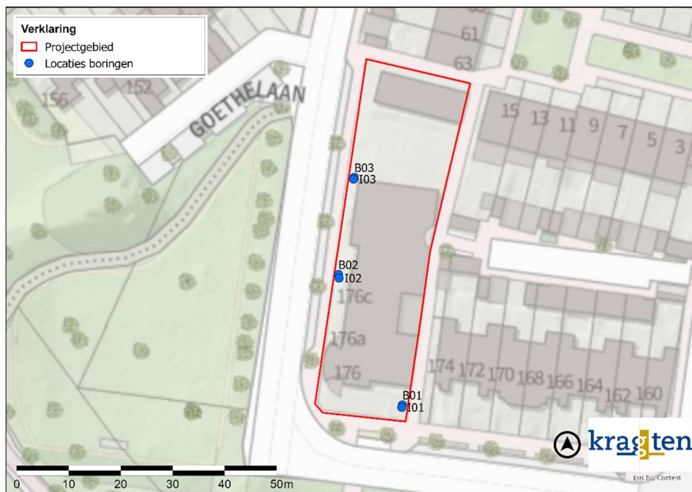
Figuur 9 locaties boringen en infiltratiemetingen
