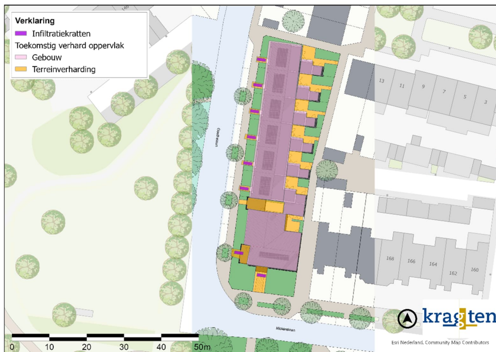
Figuur 12 Indicatie ruimtebeslag waterberging
