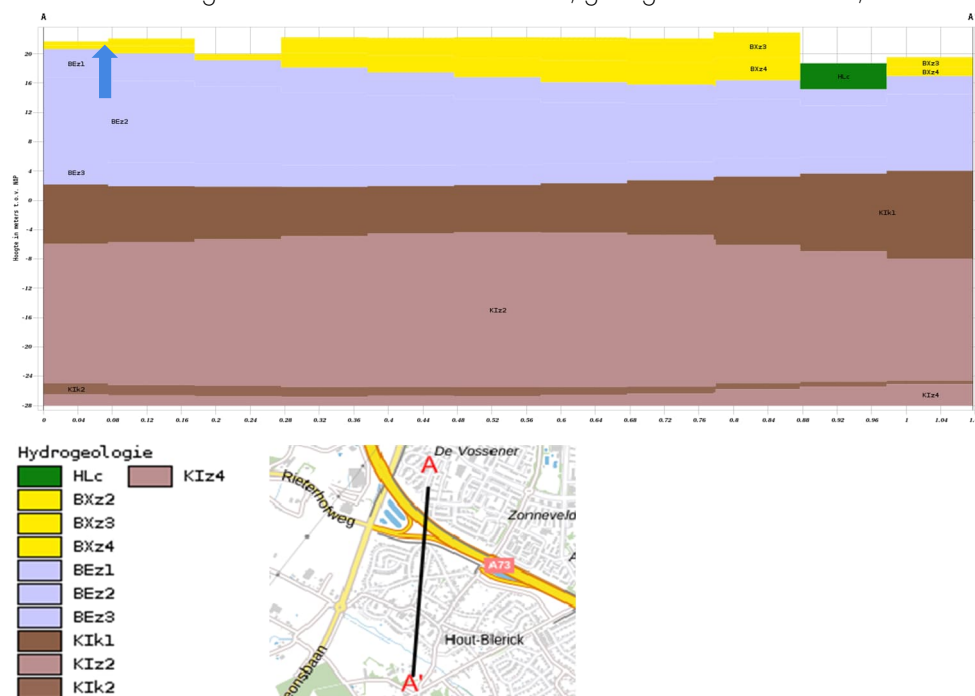
Figuur 4 Geohydrologische doorsnede met de globale locatie van het projectgebied bij de blauwe peil.
