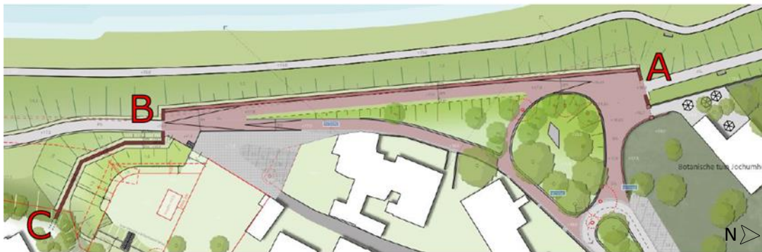
Figuur 2: Ligging Impressie van het ontwerp, met tussen punten A en B de zelfsluitende kering en tussen B en C de permanente keermuur
