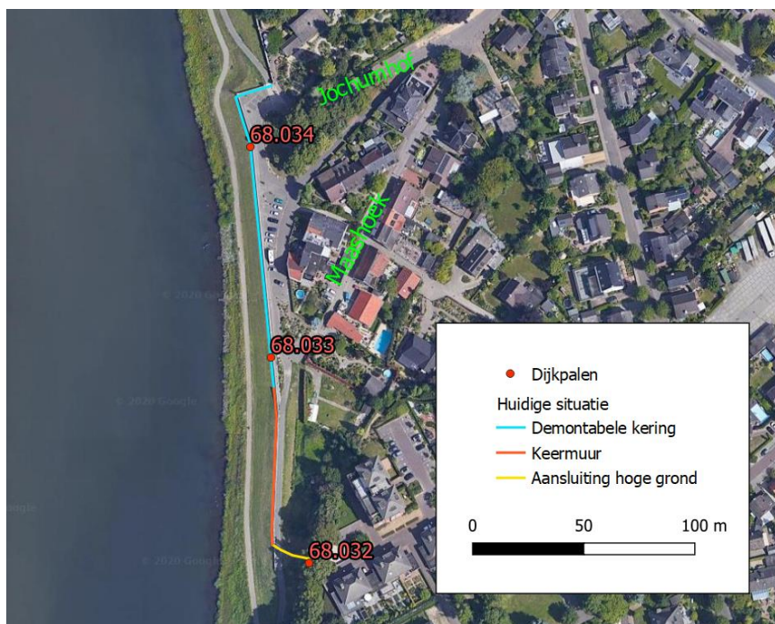
Figuur 2: Huidige constructies Steyl-Maashoek
