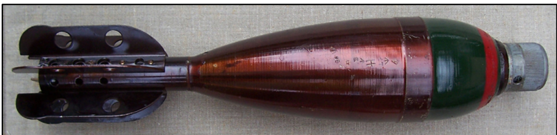
Afbeelding 28: voorbeeld van een springrookgranaat WP van 4.2 inch mortier.
