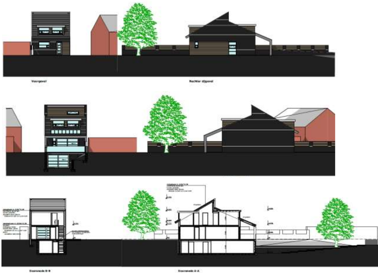
Figuur 4: Gevelaanzichten en doorsnedes beoogde woning
