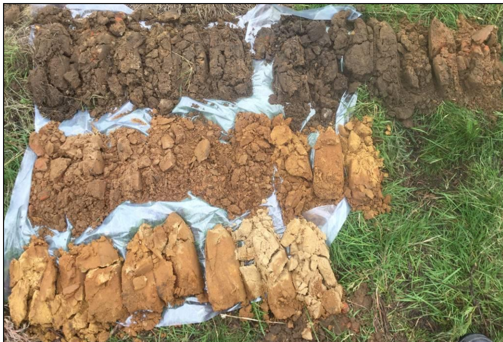
Figuur 8: Profielopname van boring 5, leesrichting van links naar rechts (Foto: november 2019).
