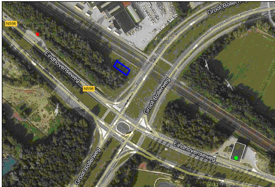
Figuur 3.2 Tankstation met vulpunt LPG (rood), bovengrondse LPG-tank (blauw), LPG-afgiftepunt (groen)
