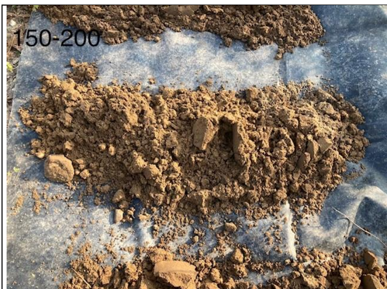
Foto 6: uitkomend grond boring 11 (traject 1,5-2,0 m-mv)
