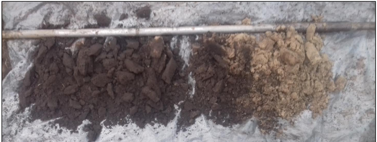
Figuur 5: boorprofiel van boring 2. De leesrichting is van rechts naar links.
