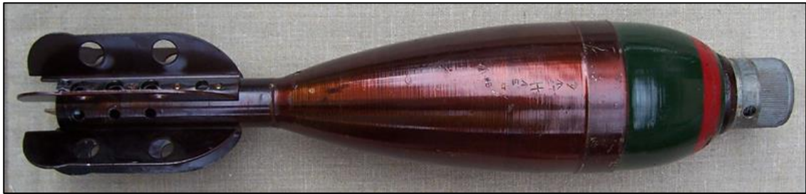
Afbeelding 18: Voorbeeld van een springrookgranaat WP van 3 inch mortier.
