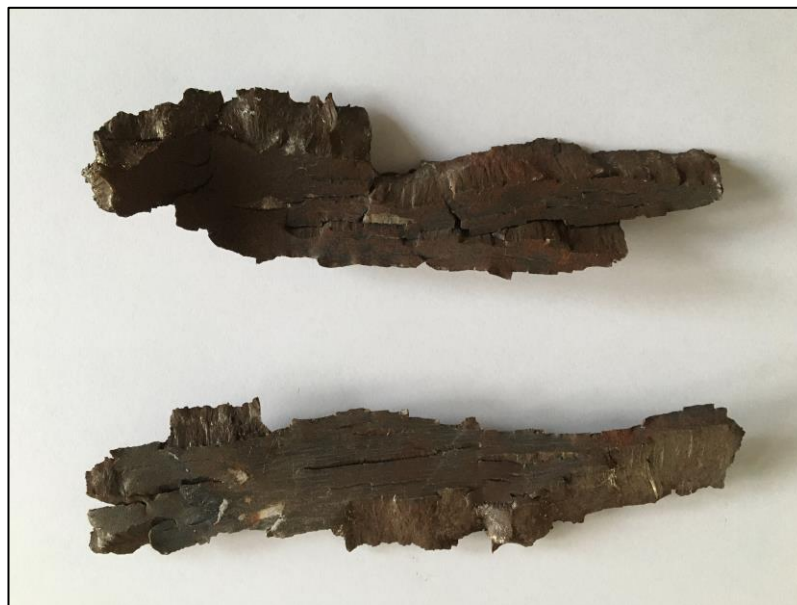
Afbeelding 19: Scherven na detonatie van een met springstof gevuld OO.
