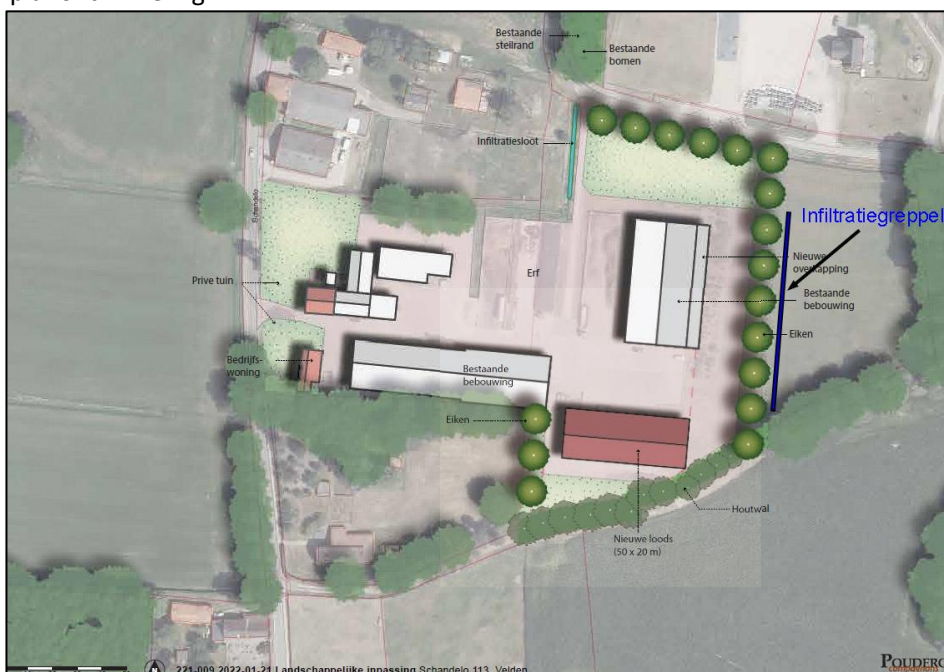
Uitsnede landschappelijk inpassingsplan met aanduiding infiltratiegreppel Schandelo 113
