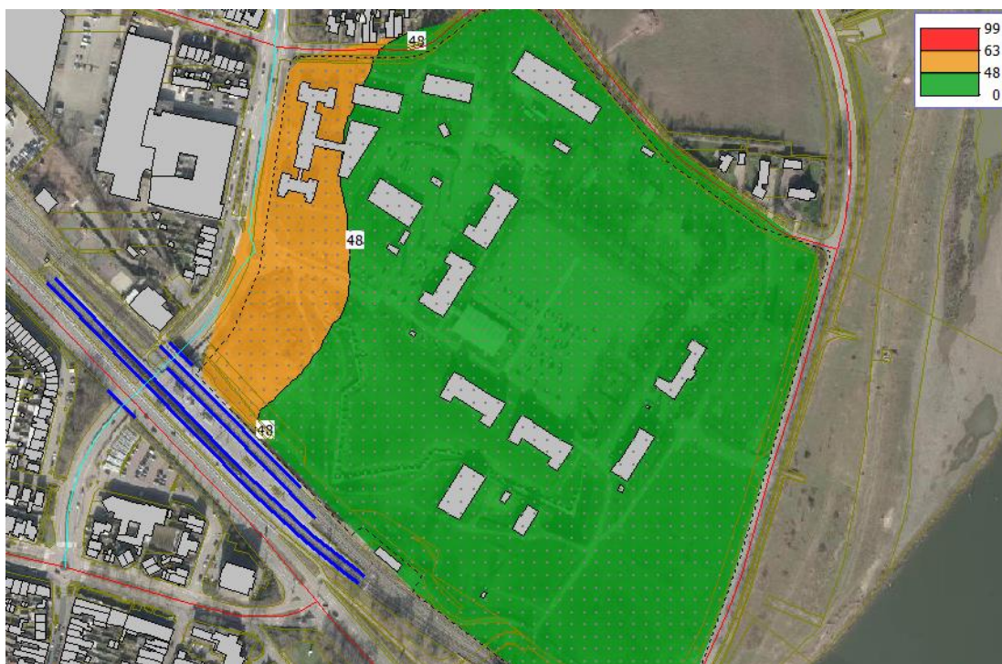
Afbeelding 5 Contouren geluidbelastingen Kazernestraat (rekenhoogte 10 meter).
