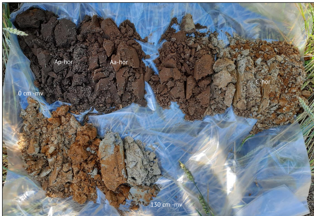
Figuur 8: Foto van boorprofiel boring 9 van de bovenste 130 centimeter. Leesrichting is van links naar rechts.
