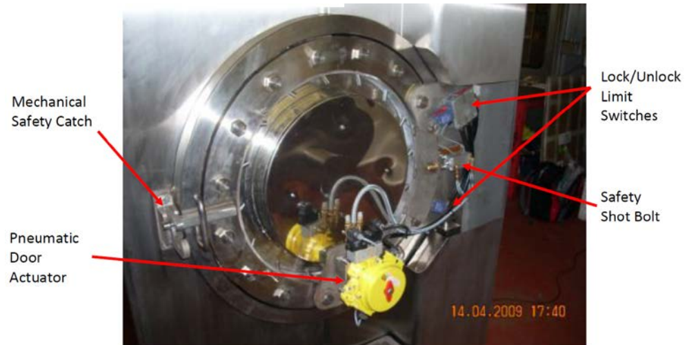
Figuur 5 Deurvergrendelingsysteem (zonder panelen) [5]
