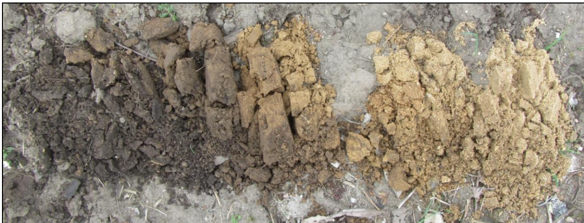
Figuur 7: Van boven naar beneden boring 2 en 6, uitgelegd van links naar rechts (0-110 cm -mv).
