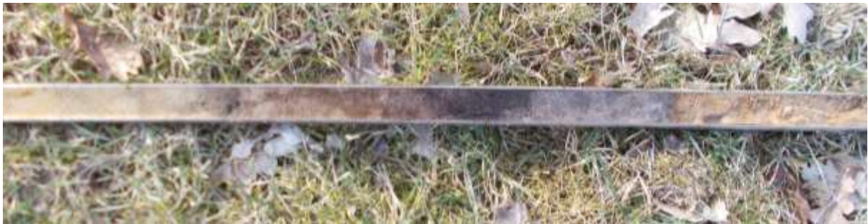
Figuur 18: Foto van de nog deel intacte podzolopbouw zoals deze op de boorpunten 10 en 20 is aangetroffen
