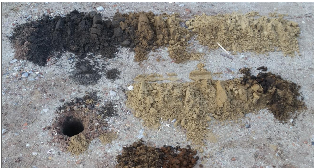
Figuur 14: Boring 2 uitgelegd van rechtsboven naar linksonder.
