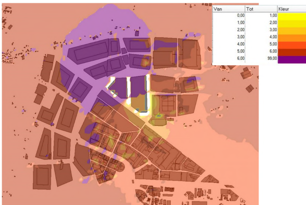
Figuur 4.1: Versil van geluidbelasting (IL) door (uitsluitend) Klaver 4 in referentiesituatie en bij de gewijzigde indeling en milieucategorie
