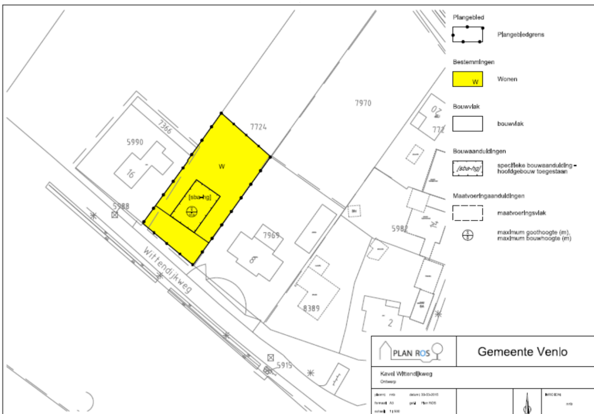
Afbeelding 2: Ontwerp kavel Wittendijkweg. Geel gemarkeerd is het plangebied. Het rechthoek binnen het gele vlak betreft de begrenzing van het bouwvlak. Kaartbron: Plan ROS.
