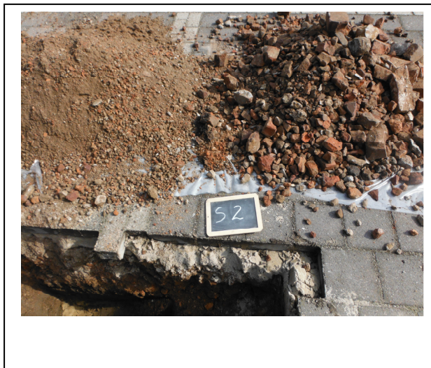
Foto 4. Opgegraven en gezeefd materiaal inspectiesleuf S02
