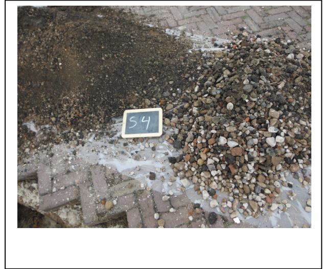
Foto 8. Opgegraven en gezeefd materiaal inspectiesleuf S04
