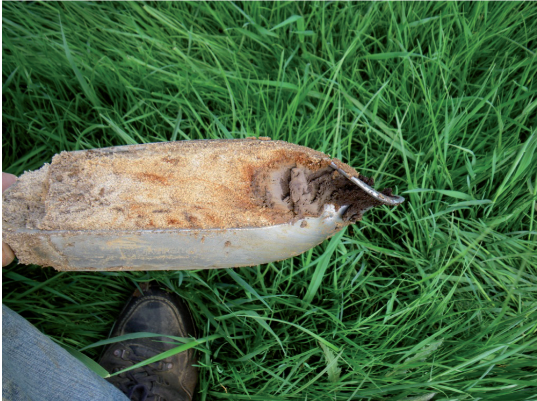
Figuur 10. Boring 39 met een zandpakket bovenop een dun sliblaagje en vervolgens venige afzettingen (in de punt van de boor).
