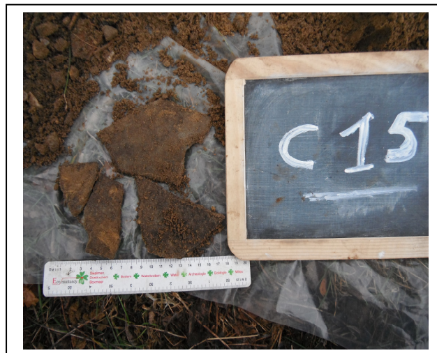
Foto 4. Gezeefd asbestverdacht golfplaatmateriaal gat/boring C15
