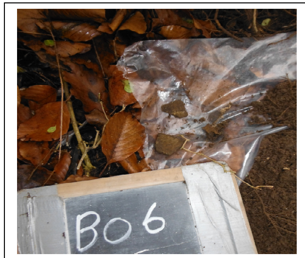
Foto 2. Gezeefd asbestverdacht plaatmateriaal gat/boring B06
