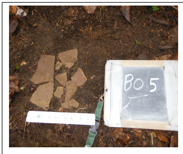
Foto 1. Gezeefd asbestverdacht plaatmateriaal gat/boring B05
