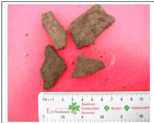
Foto 3. Gezeefd asbestverdacht golfplaatmateriaal gat/boring C12
