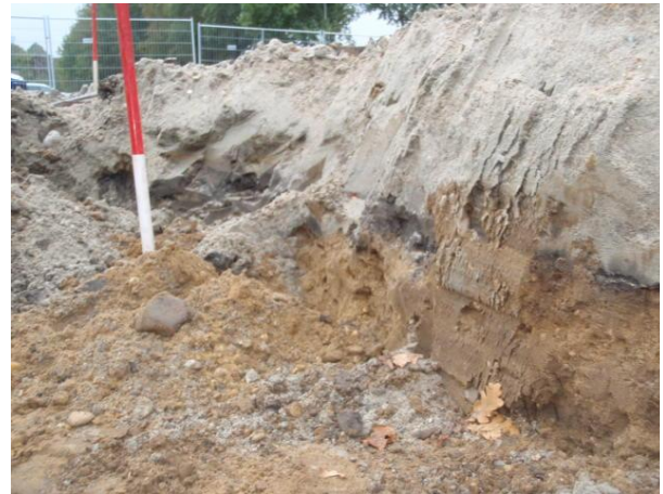
Foto 2: ter plaatse van boring 07 waar een minerale olie verontreiniging is aangetroffen.
