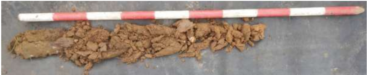
Figuur 20: Foto van boring 6. Uitgelegd van links naar rechts tot 50 cm -mv. Aan de basis gaat de pleistocene leem geleidelijk over in tertiaire verweringsleem met grof grind en vuursteen.
