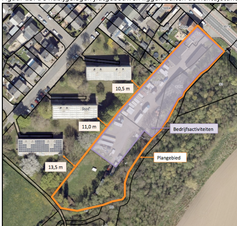
Figuur 13: De nabijgelegen flatgebouwen liggen buiten de richtafstanden vanuit milieuzonering
