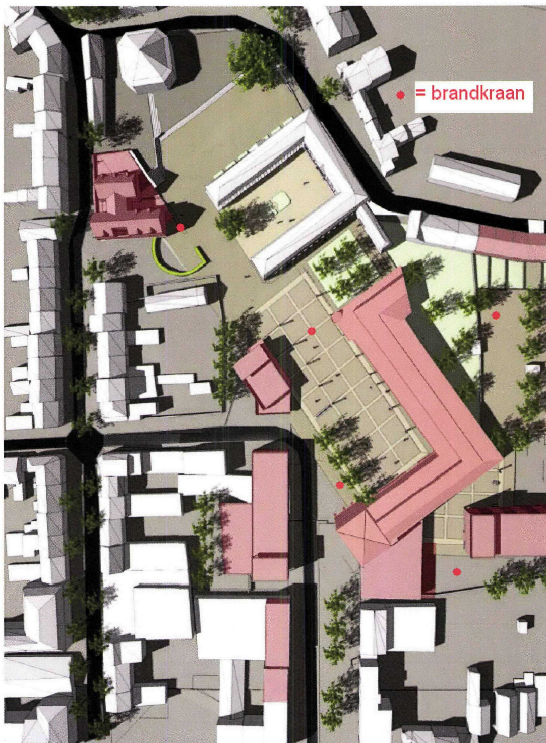
Bijlage 1, Illustratie plaatsing brandkranen.
