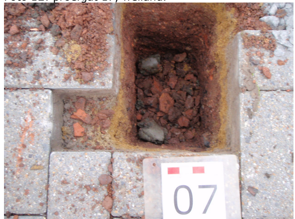
Foto 14: proefgat 07, met baksteen, recreatiegedeelte.
