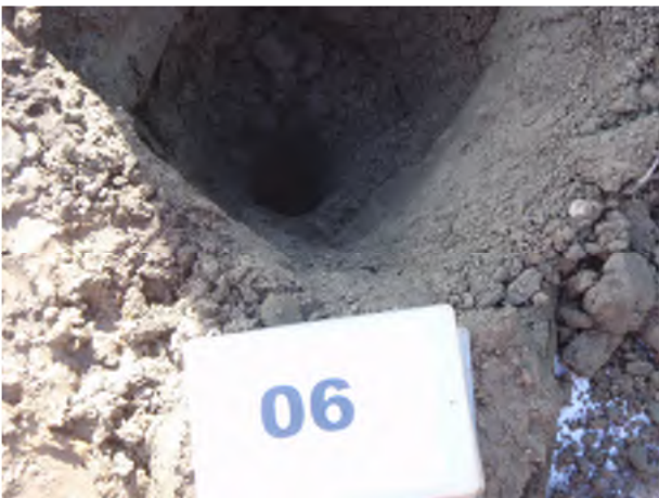
Foto 5: Voorbeeld van proefgat voor asbestonderzoek. Op 0,5 m-mv wordt met edelmanboor doorgeboord.
