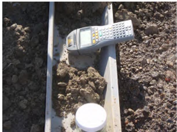
Foto 6: Alle bodemonsters worden conform de NEN 5104 beschreven en in de veldcomputer ingevoerd.
