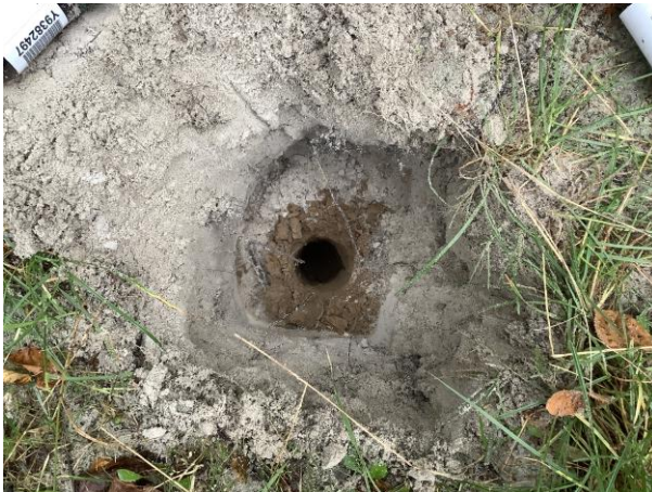
Foto 9 Inspectiegat met boring (boring 09)
