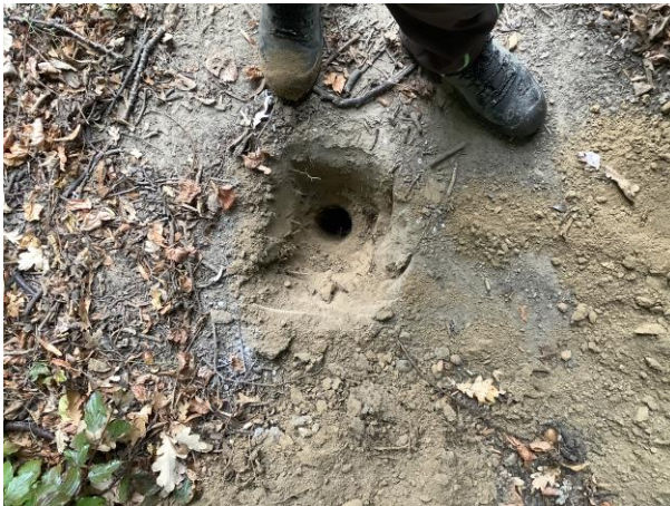
Foto 7 Inspectiegat met boring (boring 01)
