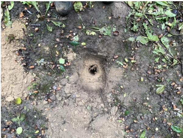
Foto 11 Inspectiegat met boring (boring 15)
